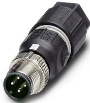
Steckverbinder, Universal, 4-polig, Stecker gerade M12 SPEEDCON, Kodierung: A, Schneidklemmanschluss, Rändelmaterial: Zinkdruckguss, vernickelt, Leitungsaußendurchmesser 4 mm ... 8 mm
