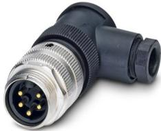
Steckverbinder, Universal, 5-polig, Stecker gewinkelt 7/8"-16UNF, Kodierung: A, Schraubanschluss, Rändelmaterial: Zinkdruckguss, vernickelt, Kabelverschraubung Pg9, Leitungsaußendurchmesser 6 mm ... 8 mm, Kontakt 3 voreilend
