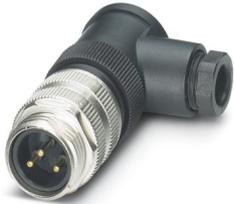
Steckverbinder, Universal, 3-polig, Stecker gewinkelt 7/8"-16UNF, Kodierung: A, Schraubanschluss, Rändelmaterial: Zinkdruckguss, vernickelt, Kabelverschraubung Pg9, Leitungsaußendurchmesser 6 mm ... 8 mm, Kontakt 1 voreilend
