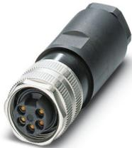
Steckverbinder, Universal, 5-polig, Buchse gerade 7/8"-16UNF, Kodierung: A, Schraubanschluss, Rändelmaterial: Zinkdruckguss, vernickelt, Kabelverschraubung Pg13,5, Leitungsaußendurchmesser 10 mm ... 12 mm
