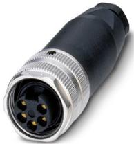
Steckverbinder, Universal, 5-polig, Buchse gerade 7/8"-16UNF, Kodierung: A, Schraubanschluss, Rändelmaterial: Zinkdruckguss, vernickelt, Kabelverschraubung Pg9, Leitungsaußendurchmesser 6 mm ... 8 mm
