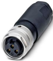
Steckverbinder, Universal, 3-polig, Buchse gerade 7/8"-16UNF, Kodierung: A, Schraubanschluss, Rändelmaterial: Zinkdruckguss, vernickelt, Kabelverschraubung Pg13,5, Leitungsaußendurchmesser 10 mm ... 12 mm
