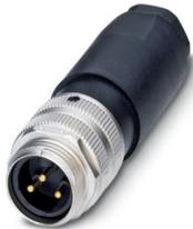
Steckverbinder, Universal, 3-polig, Stecker gerade 7/8"-16UNF, Kodierung: A, Schraubanschluss, Rändelmaterial: Zinkdruckguss, vernickelt, Kabelverschraubung Pg13,5, Leitungsaußendurchmesser 10 mm ... 12 mm, Kontakt 1 voreilend
