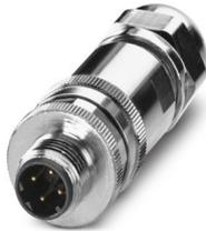
Datensteckverbinder, Ethernet CAT5 (100 MBit/s), 4-polig, geschirmt, Stecker gerade M12, Kodierung: D, Schraubanschluss, Rändelmaterial: Messing, vernickelt, Kabelverschraubung Pg9, Leitungsaußendurchmesser 6 mm ... 8 mm
