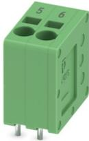
Leiterplattenklemme, Nennstrom: 17,5 A, Bemessungsspannung (III/2): 200 V, Nennquerschnitt: 1,5 mm<sup>2</sup>, Anzahl der Reihen: 1, Polzahl pro Reihe: 2, Artikelfamilie: SPT 1,5/..-V, Rastermaß: 3,5 mm, Anschlussart: Push-in-Federanschluss, Montage: Wellenlöten, Anschlussrichtung Leiter/Platine: 90 °, Farbe: grün, Pin-Layout: Lineares Pinning, Pinlänge [P]: 2,5 mm, Anzahl der Lötpins pro Potenzial: 2, Verpackungsart: verpackt im Karton
