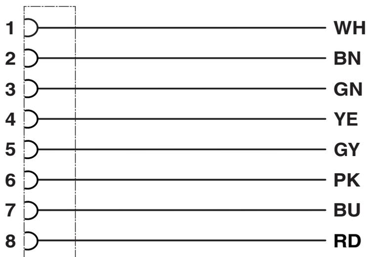
Kontaktbelegung der M12-Buchse
