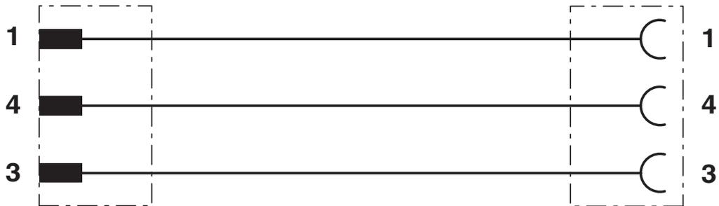
Kontaktbelegung der M8-Stecker / M12-Buchse
