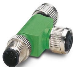
T-Verteiler, 5-polig, ungeschirmt, Stecker gerade M12, Kodierung: A, auf Buchse gerade M12, Kodierung: A, PIN 2+4 gebrückt und Buchse gerade M12, Kodierung: A, PIN 2+4 gebrückt
