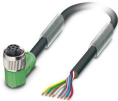
Sensor-/Aktor-Kabel, 8-polig, PUR halogenfrei, schwarzgrau RAL 7021, freies Leitungsende, auf Buchse gewinkelt M12, Kodierung: A, Kabellänge: 50 m
