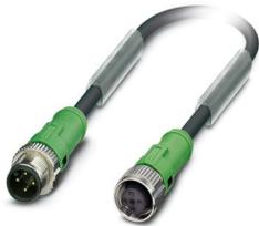
Sensor-/Aktor-Kabel, 4-polig, PUR halogenfrei, schwarzgrau RAL 7021, Stecker gerade M12 SPEEDCON, Kodierung: A, auf Buchse gerade M12 SPEEDCON, Kodierung: A, Kabellänge: 1,5 m
