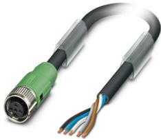
Sensor-/Aktor-Kabel, 5-polig, PUR, schwarzgrau RAL 7021, freies Leitungsende, auf Buchse gerade M12 SPEEDCON, Kodierung: A, Kabellänge: 15 m
