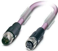
Bussystem-Kabel, CANopen®, DeviceNet™, 5-polig, PUR halogenfrei, violett RAL 4001, geschirmt, Stecker gerade M12 SPEEDCON, Kodierung: A, auf Buchse gerade M12 SPEEDCON, Kodierung: A, Kabellänge: 2 m
