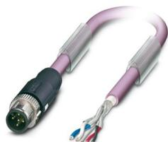
Bussystem-Kabel, CANopen®, DeviceNet™, 5-polig, PUR halogenfrei, violett RAL 4001, geschirmt, Stecker gerade M12 SPEEDCON, Kodierung: A, auf freies Leitungsende, Kabellänge: 15 m
