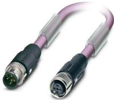
Bussystem-Kabel, PROFIBUS (12 MBit/s), 2-polig, PUR halogenfrei, violett RAL 4001, geschirmt, Stecker gerade M12 SPEEDCON, Kodierung: B, auf Buchse gerade M12 SPEEDCON, Kodierung: B, Kabellänge: 0,5 m
