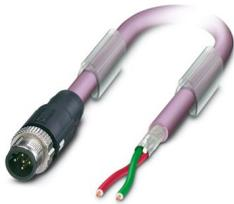
Bussystem-Kabel, PROFIBUS (12 MBit/s), 2-polig, PUR halogenfrei, violett RAL 4001, geschirmt, Stecker gerade M12 SPEEDCON, Kodierung: B, auf freies Leitungsende, Kabellänge: 10 m
