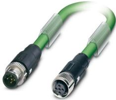
Bussystem-Kabel, INTERBUS (16 MBit/s), 5-polig, PUR halogenfrei, maigrün RAL 6017, geschirmt, Stecker gerade M12 SPEEDCON, Kodierung: B, auf Buchse gerade M12 SPEEDCON, Kodierung: B, Kabellänge: 1 m
