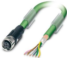
Bussystem-Kabel, INTERBUS (16 MBit/s), 5-polig, PUR halogenfrei, maigrün RAL 6017, geschirmt, freies Leitungsende, auf Buchse gerade M12 SPEEDCON, Kodierung: B, Kabellänge: 2 m
