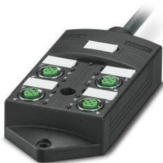
Verteilerbox, Anwendung: Standard, erweiterte Anforderungen, Anschlussart: M12-Buchse Metall, Anzahl der Steckplätze: 4, Polzahl: 5, Kodierung: A, Steckplatzbelegung: doppelt, Statusanzeige: ja, PNP; Stammlenitungsanschluss: Festanschluss 180°, PUR/PVC, Leitungslänge: 10 m, Schirmung: nein
