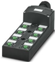
Verteilerbox, Anwendung: Standard, erweiterte Anforderungen, Anschlussart: M12-Buchse Metall, Anzahl der Steckplätze: 8, Polzahl: 5, Kodierung: A, Steckplatzbelegung: doppelt, Statusanzeige: ja, PNP; Stammleitungsanschluss: Steckbarer Schraubanschluss 180°, Schirmung: nein
