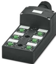
Verteilerbox, Anwendung: Standard, erweiterte Anforderungen, Anschlussart: M12-Buchse Metall, Anzahl der Steckplätze: 6, Polzahl: 5, Kodierung: A, Steckplatzbelegung: doppelt, Statusanzeige: ja, PNP; Stammleitungsanschluss: Steckbarer Schraubanschluss 180°, Schirmung: nein
