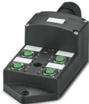
Verteilerbox, Anwendung: Standard, erweiterte Anforderungen, Anschlussart: M12-Buchse Metall, Anzahl der Steckplätze: 4, Polzahl: 4, Kodierung: A, Steckplatzbelegung: einfach, Statusanzeige: ja, PNP; Stammleitungsanschluss: Steckbarer Schraubanschluss 180°, Schirmung: nein
