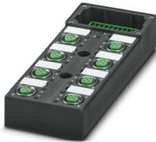
Grundgehäuse, Anwendung: Standard, erweiterte Anforderungen, Anschlussart: M12-Buchse Metall, Anzahl der Steckplätze: 8, Polzahl: 5, Kodierung: A, Steckplatzbelegung: doppelt, Statusanzeige: ja, PNP; Stammleitungsanschluss: Steckbarer Schraubanschluss, Schirmung: nein
