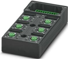
Grundgehäuse-Verteilerbox, Anwendung: Standard, erweiterte Anforderungen, Anschlussart: M12-Buchse Metall, Anzahl der Steckplätze: 6, Polzahl: 5, Kodierung: A, Steckplatzbelegung: doppelt, Statusanzeige: ja, PNP; Stammleitungsanschluss: Steckbarer Schraubanschluss, Schirmung: nein
