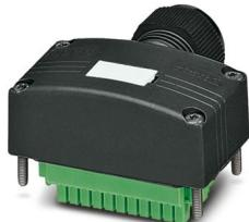
Anschlusshaube, Anwendung: Sensor-/Aktor-Box, Anschlussart: M12-Buchse Metall / QUICKON, Anzahl der Steckplätze: 8, Steckplatzbelegung: doppelt, Statusanzeige: nein; Stammleitungsanschluss: Steckbarer Schraubanschluss 180°, PUR/PVC, Leitungslänge: 5 m, Schirmung: nein
