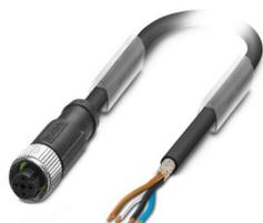
Sensor-/Aktor-Kabel, 4-polig, PUR halogenfrei, schwarzgrau RAL 7021, geschirmt (Advanced Shielding Technology), freies Leitungsende, auf Buchse gerade M12, Kodierung: A, Kabellänge: 20 m
