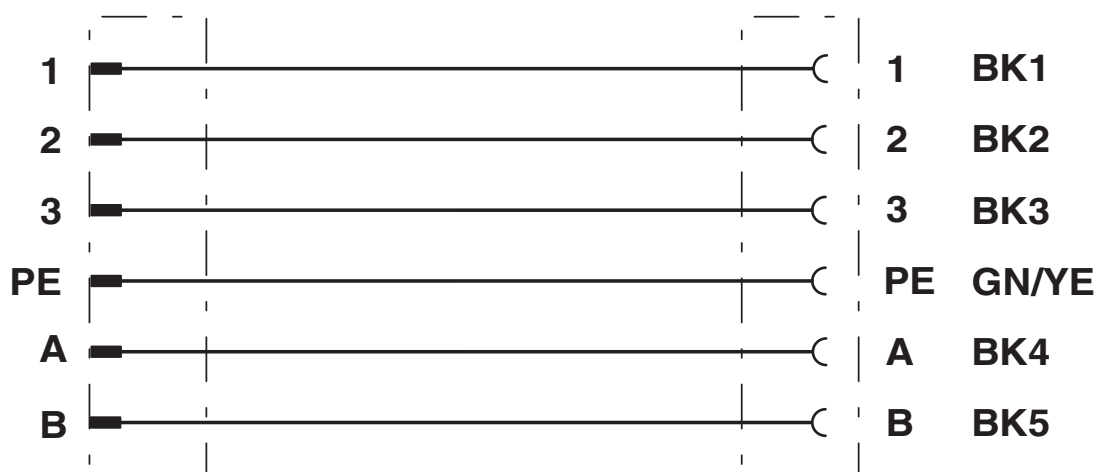
Kontaktbelegung des S15-Steckers und der S15-Buchse
