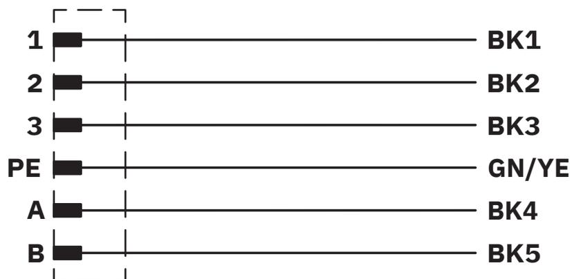
Kontaktbelegung des M15-Steckers
