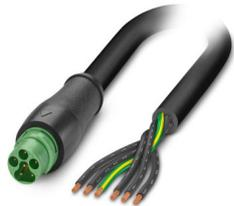
Powerleitung, 6-polig, PUR halogenfrei, schwarz, Stecker gerade Größe 15 Bajonettverriegelung , auf freies Leitungsende, Kabellänge: 3 m, für Wechselstrom bis 16 A/600 V
