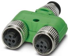
Y-Verteiler, 5-polig, ungeschirmt, Stecker gerade M12, Kodierung: A, auf Buchse gerade M12, Kodierung: A und Buchse gerade M12, Kodierung: A, parallel Verteiler
