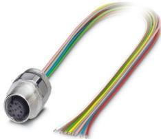
Gerätesteckverbinder Vorderwand, Universal, 8-polig, Buchse, gerade, M12-Standard, A-Kodierung, auf freies Leitungsende, Einzellitzen, Kabellänge: 0,5 m, 0,25 mm<sup>2</sup>, TPE-Litze, vergossen, dieser Artikel ist voraussichtlich ab 2026-Q1 nach RoHS II ohne Ausnahme 6c (Pb < 0,1 %) bleifrei, auf Anfrage ist eine bleifreie Alternative vorab möglich
