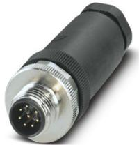
Steckverbinder, Universal, 8-polig, Stecker gerade M12, Kodierung: A, Schraubanschluss, Rändelmaterial: Messing, vernickelt, Kabelverschraubung Pg9, Leitungsaußendurchmesser 6 mm ... 8 mm
