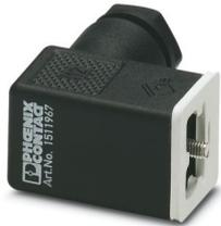
Ventilstecker, Universal, 4-polig, Ventilstecker C (8 mm), Schraubanschluss, Kabelverschraubung Pg9, Leitungsaußendurchmesser 4 mm ... 6 mm
