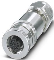
Steckverbinder, Universal, 8-polig, geschirmt, Buchse gerade M12, Kodierung: A, Schraubanschluss, Rändelmaterial: Messing, vernickelt, Leitungsaußendurchmesser 6 mm ... 8 mm
