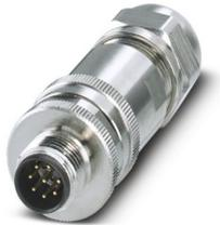
Steckverbinder, Universal, 8-polig, geschirmt, Stecker gerade M12, Kodierung: A, Schraubanschluss, Rändelmaterial: Messing, vernickelt, Leitungsaußendurchmesser 6 mm ... 8 mm
