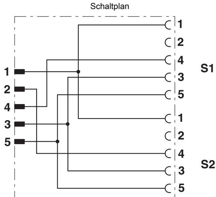
Kontaktbelegung des M12-Y-Verteilers
