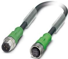
Sensor-/Aktor-Kabel, 4-polig, PUR, schwarzgrau RAL 7021, Stecker gerade M12, Kodierung: A, auf Buchse gerade M12, Kodierung: A, Kabellänge: 2 m
