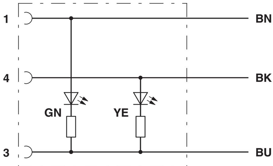
Kontaktbelegung der M12-Buchse
