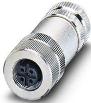
Datensteckverbinder, PROFIBUS, INTERBUS, 5-polig, geschirmt, Buchse gerade M12, Kodierung: B, Schraubanschluss, Rändelmaterial: Zinkdruckguss, vernickelt, Kabelverschraubung Pg9, Leitungsaußendurchmesser 6,5 mm ... 8,5 mm
