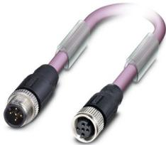
Bussystem-Kabel, CANopen®, DeviceNet™, 5-polig, PUR halogenfrei, violett RAL 4001, geschirmt, Stecker gerade M12, Kodierung: A, auf Buchse gerade M12, Kodierung: A, Kabellänge: 2 m
