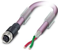
Bussystem-Kabel, PROFIBUS (12 MBit/s), 2-polig, PUR halogenfrei, violett RAL 4001, geschirmt, freies Leitungsende, auf Buchse gerade M12, Kodierung: B, Kabellänge: 5 m
