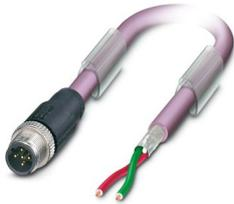
Bussystem-Kabel, PROFIBUS (12 MBit/s), 2-polig, PUR halogenfrei, violett RAL 4001, geschirmt, Stecker gerade M12, Kodierung: B, auf freies Leitungsende, Kabellänge: 5 m
