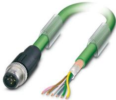
Bussystem-Kabel, INTERBUS (16 MBit/s), 5-polig, PUR halogenfrei, maigrün RAL 6017, geschirmt, Stecker gerade M12, Kodierung: B, auf freies Leitungsende, Kabellänge: 15 m
