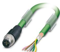
Bussystem-Kabel, INTERBUS (16 MBit/s), 5-polig, PUR halogenfrei, maigrün RAL 6017, geschirmt, Stecker gerade M12, Kodierung: B, auf freies Leitungsende, Kabellänge: 10 m
