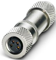
Steckverbinder, Universal, 4-polig, geschirmt, Buchse gerade M8, Kodierung: A, Lötanschluss, Rändelmaterial: Messing, vernickelt, Leitungsaußendurchmesser 3,5 mm ... 5 mm
