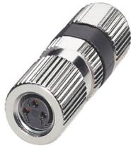
Steckverbinder, Universal, 3-polig, Buchse gerade M8, Kodierung: A, Piercecon®-Schnellanschluss, Rändelmaterial: Messing, vernickelt, Leitungsaußendurchmesser 3 mm ... 5 mm
