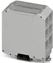
Tragschienengehäuse, Flache Bauform, ohne Lüftungsschlitze, Breite: 45 mm, Höhe: 85 mm, Tiefe: 92 mm, Farbe: grau (ähnlich RAL 7042), Querverbindung: Tragschienen-Busverbinder (optional), Polzahl Querverbinder: 5
