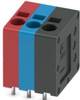
Leiterplattenklemme, Nennstrom: 17,5 A, Bemessungsspannung (III/2): 200 V, Nennquerschnitt: 1,5 mm<sup>2</sup>, Anzahl der Reihen: 1, Polzahl pro Reihe: 3, Artikelfamilie: SPT 1,5/..-V, Rastermaß: 3,5 mm, Anschlussart: Push-in-Federanschluss, Montage: Wellenlöten, Anschlussrichtung Leiter/Platine: 90 °, Farbe: mehrfarbig, Pin-Layout: Lineares Pinning, Pinlänge [P]: 2,5 mm, Anzahl der Lötpins pro Potenzial: 2, Verpackungsart: verpackt im Karton
